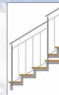
Geländertyp 200: Eckpfosten-System Banister model 200: Corner post system
