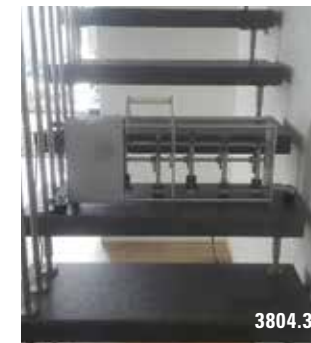
Bild 3: Schallschutzprüfung fig. 3: sound insulation test
